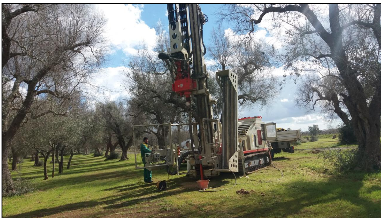
Foto 16. Esecuzione della prova di permeabilità in foro PE4.
