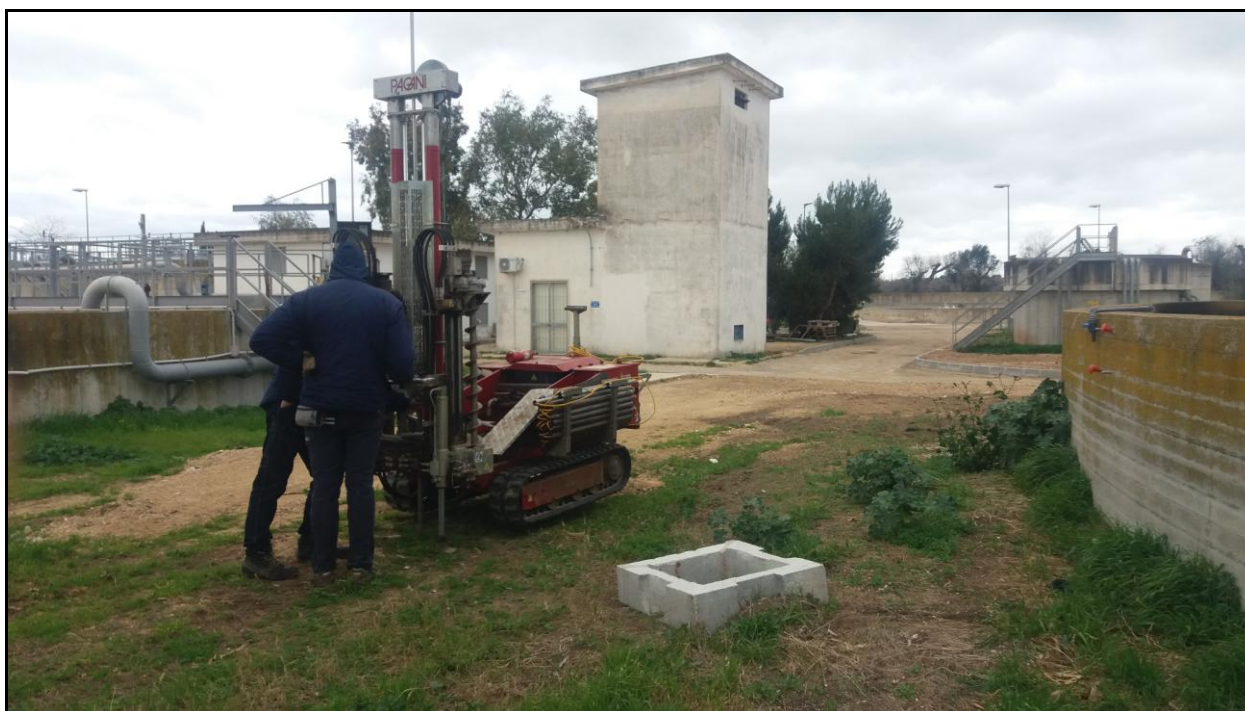
Foto 9. Esecuzione del sondaggio penetrometrico DPSH5.
