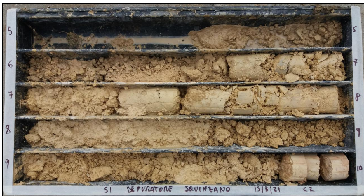
Foto 3. Sondaggio S1 - Casseta catalogatrice n° 2 (5,00-10,00 m).
