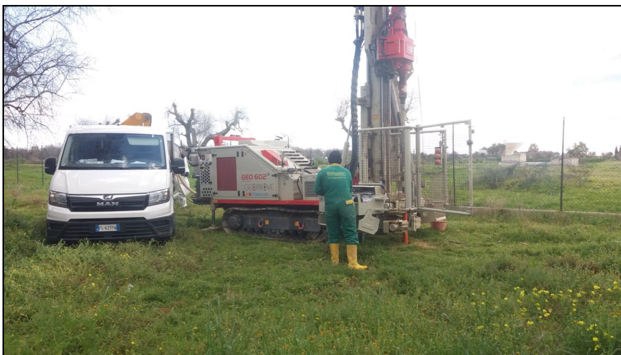
Foto 14. Esecuzione della prova di permeabilità in foro PE2.
