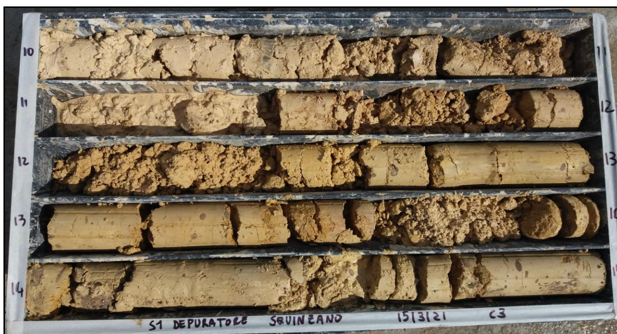
Foto 4. Sondaggio S1 - Casseta catalogatrice n° 3 (10,00-15,00 m).
