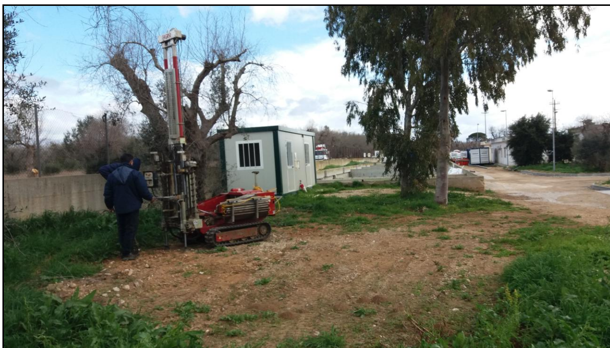
Foto 7. Esecuzione del sondaggio penetrometrico DPSH3.
