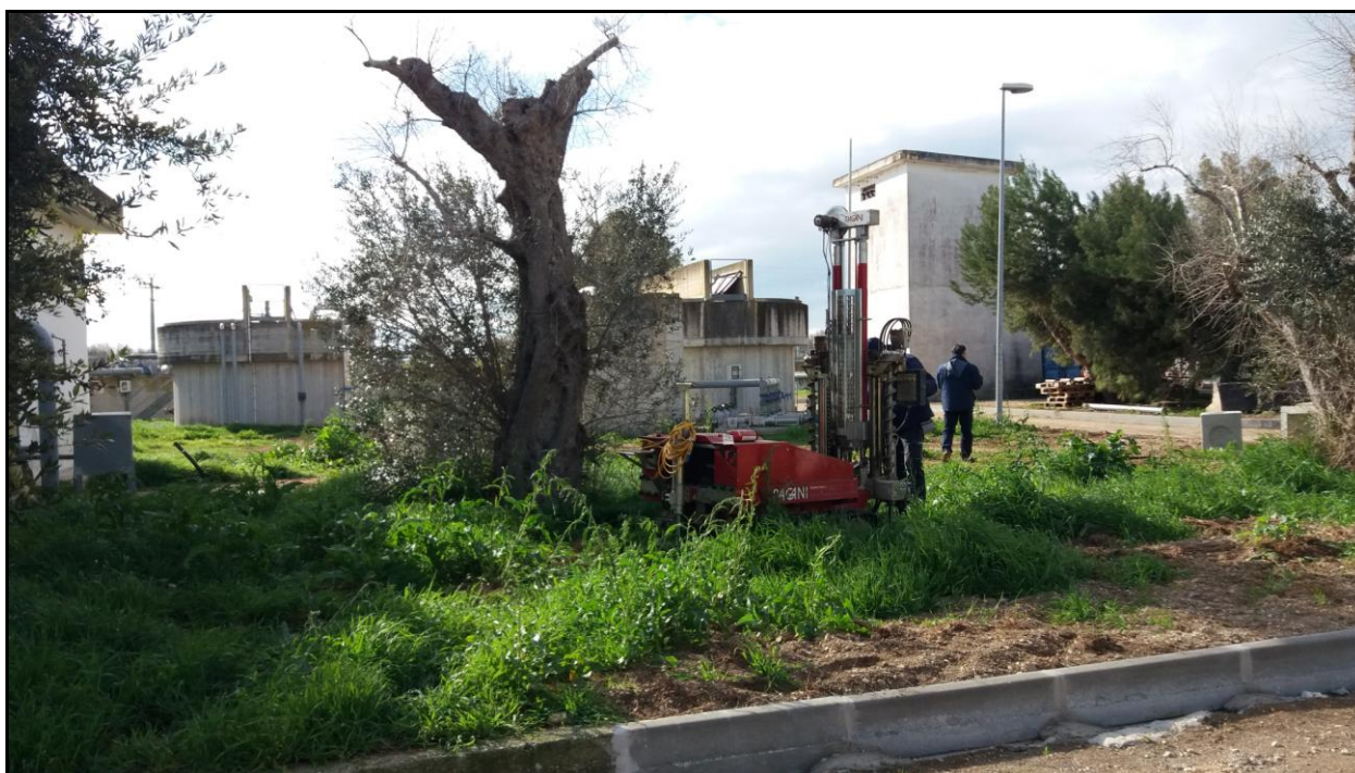
Foto 6. Esecuzione del sondaggio penetrometrico DPSH2.
