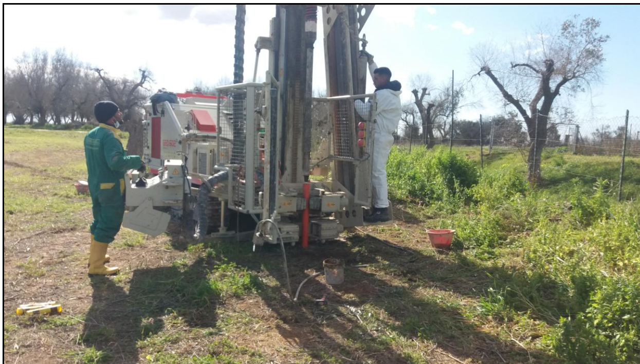
Foto 13. Esecuzione della prova di permeabilità in foro PE1.
