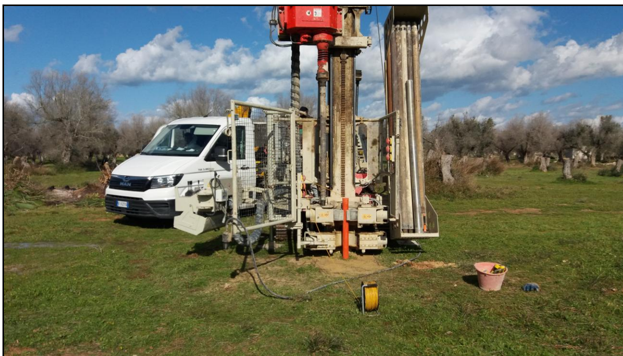
Foto 17. Esecuzione della prova di permeabilità in foro PE5.
