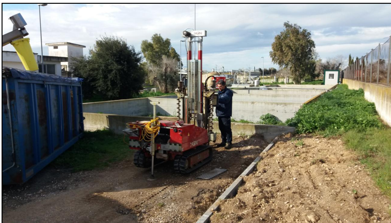
Foto 5. Esecuzione del sondaggio penetrometrico DPSH1.
