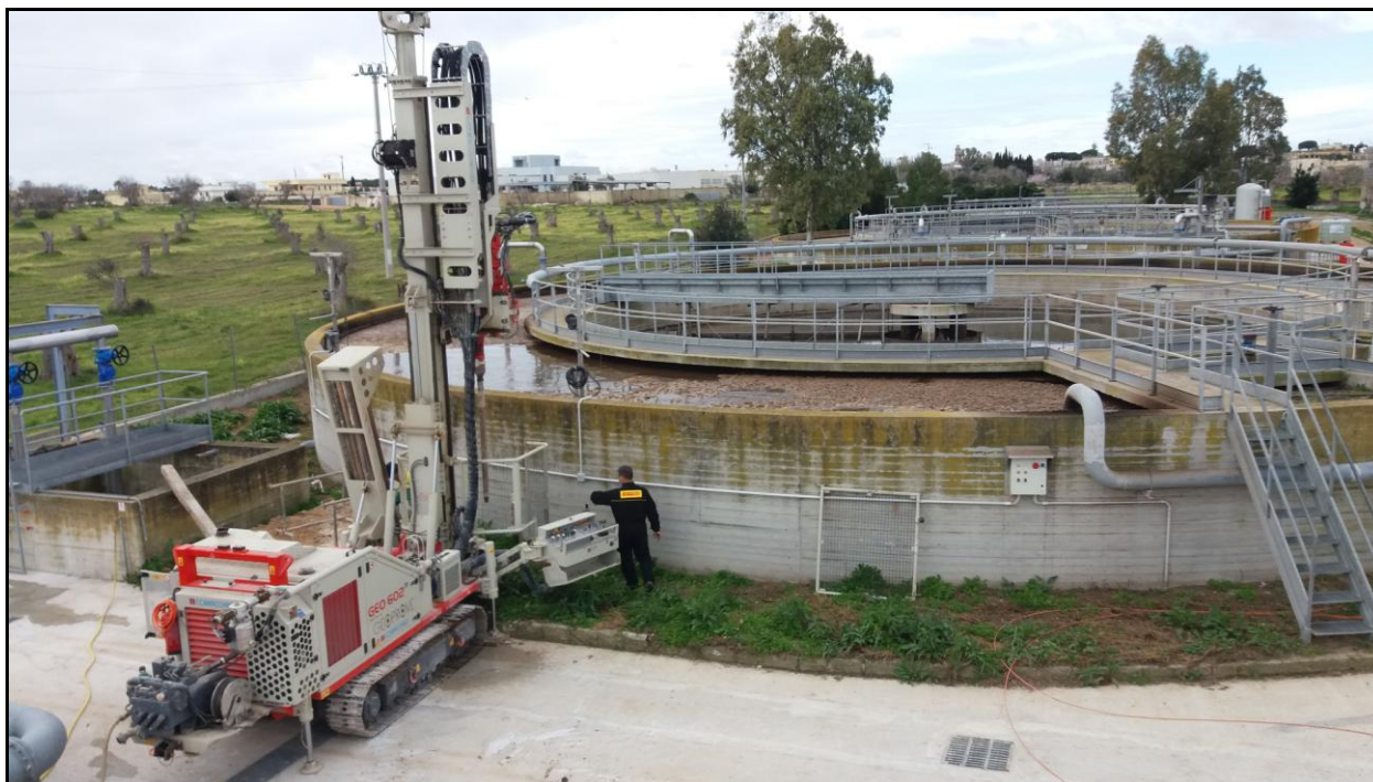
Foto 1. Realizzazione del sondaggio meccanico S1.
