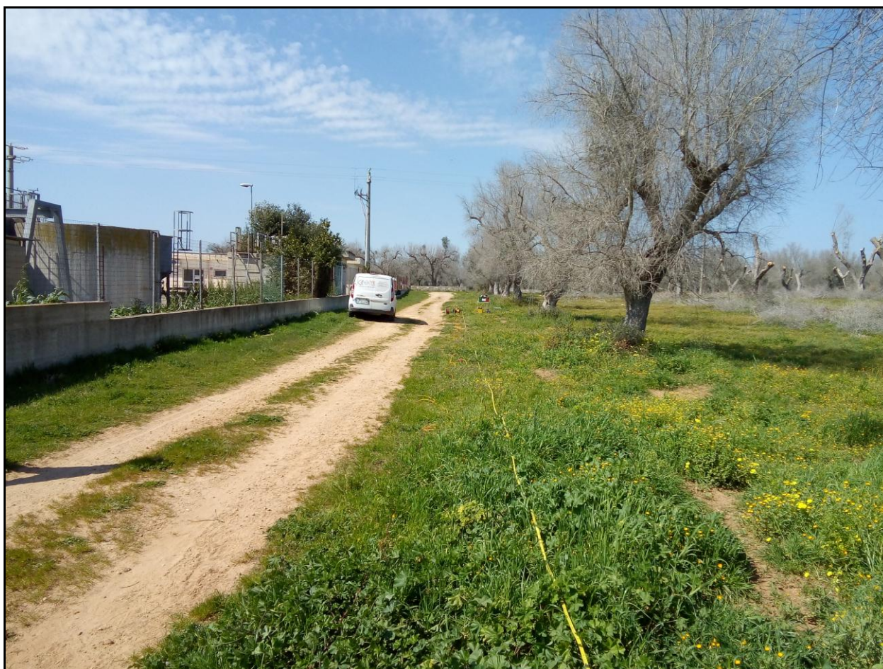
Foto 21. Esecuzione del profilo sismico P2 e dell'acquisizione MASW1, eseguiti lungo lo stesso allineamento.
