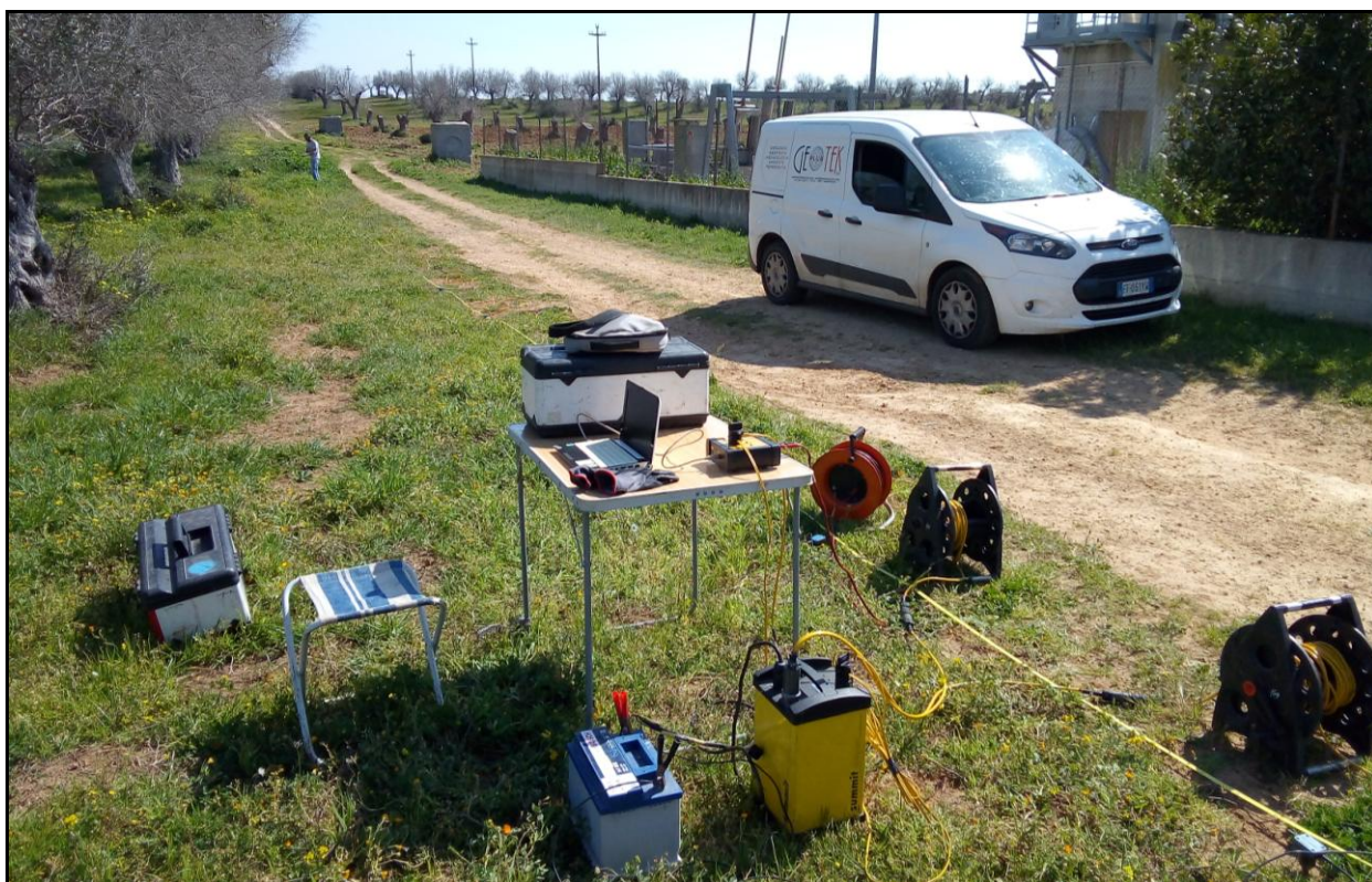
Foto 19. Postazione di acquisizione delle prospezioni sismiche.
